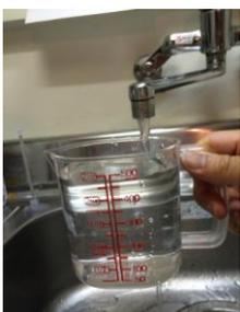
水道水で希釈し2,000ppmに調整する
