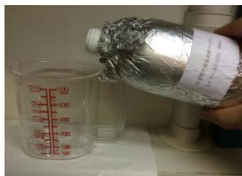
シュフレクイックの原料となる安定型次亜塩素酸ナトリウムの原液10,000ppm溶液を計量カップに注ぎ入れる
