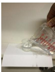
希釈した溶液を小分けし、カットしたサンプルをべた漬ける。40分間浸し、上下を反対にして再び40分間漬ける
